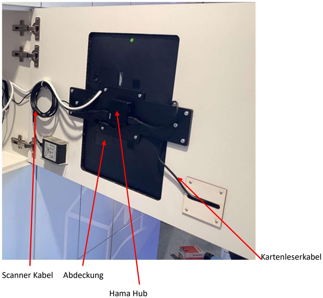
2. Trennen Sie beide Kabel (Scanner Kabel und Kartenleserkabel) von dem Hama Hub
